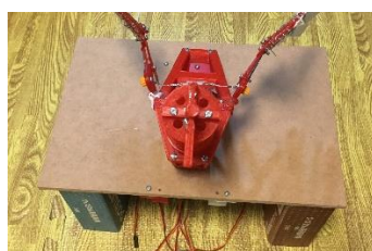
サーボモータを取り付けたホルダー、MDF ボードとホルダーを取り付けた様子
